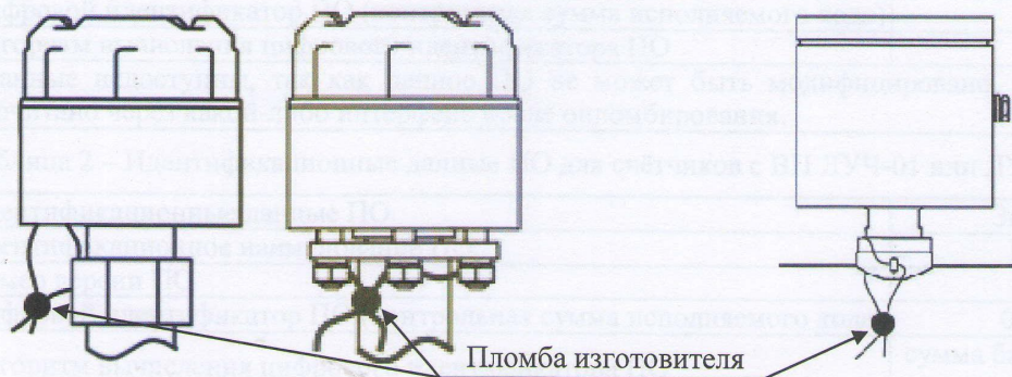
Рисунок 17 – Схема пломбировки ВП ЛУЧ-01 и ЛУЧ-02
